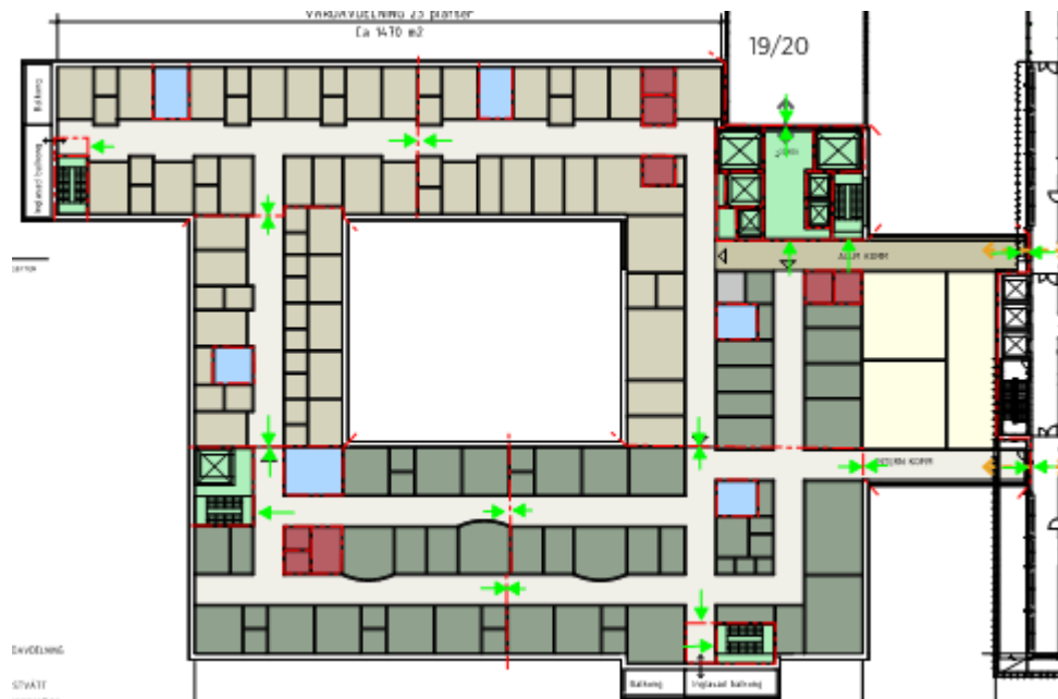
Figur 3. Principer för brandcellsindelning och utrymning för lågdelen.
